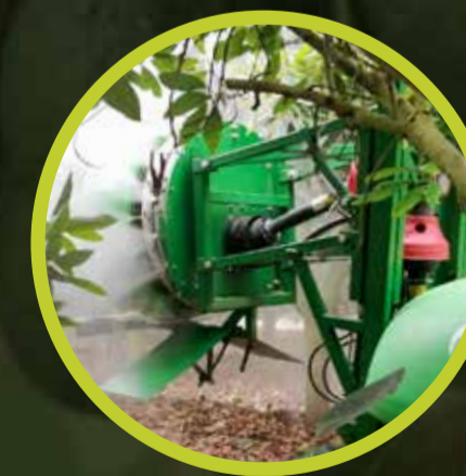
Volumen de aire de 81,000 m3/h
