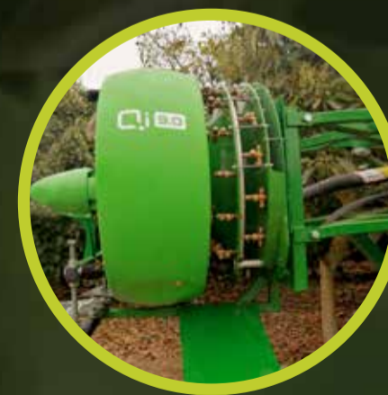
26 Boquillas con tres canales de salida de aire
